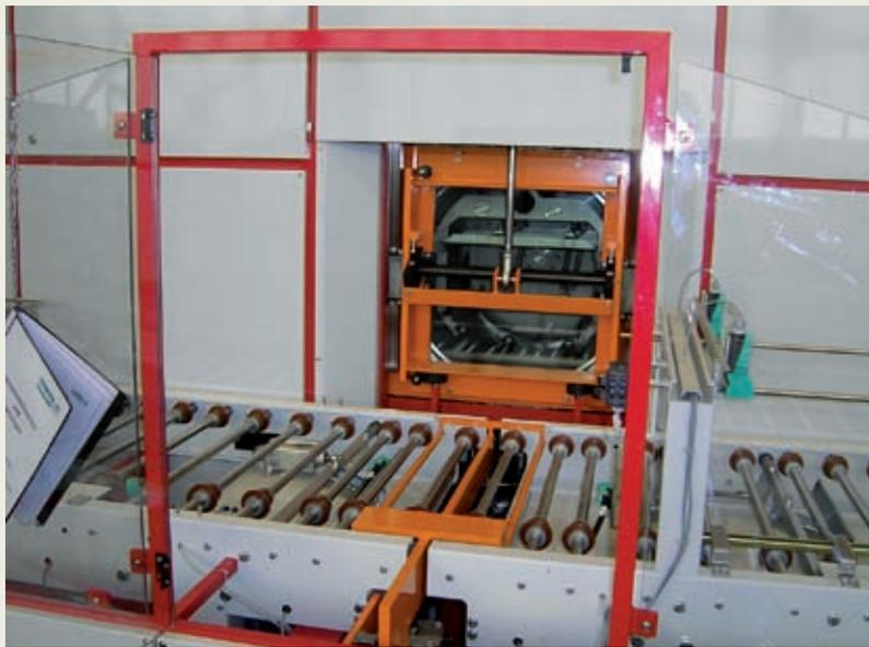
Dank Glas-Hubtüre lässt sich der Reinigungs- und Trocknungsprozess optimal beobachten und einstellen
