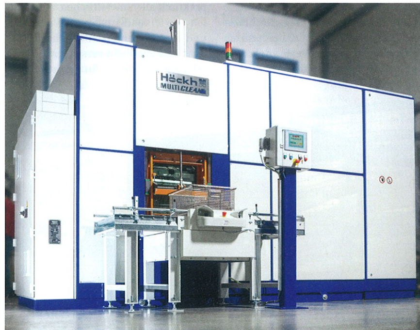
Frontansicht der Vollvakuum-Präzisions-Reinigungsanlage auf Basis von modifiziertem Alkohol. Die Bedienung erfolgt über ein mehrsprachiges Menü wahlweise auf Deutsch, Englisch oder Chinesisch.
