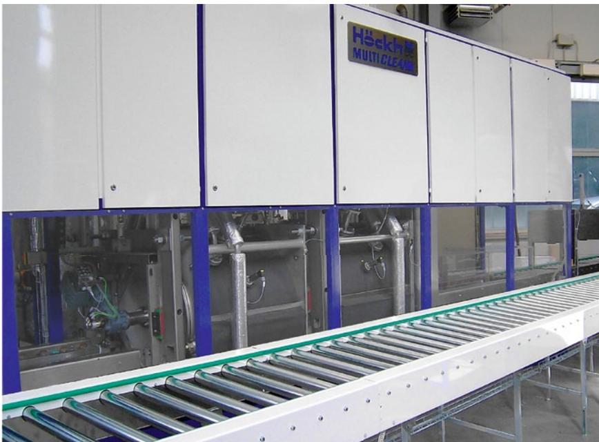
Die Durchlaufanlage für die Endreinigung von Schaltplatten befördert die gereinigten Teile direkt in einen Reinraum zur Montage
