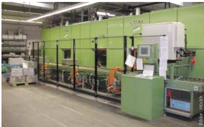
Der maximal 8-stufige Reinigungs- und Trocknungsprozess ist auf insgesamt drei Arbeitskammern aufgeteilt
