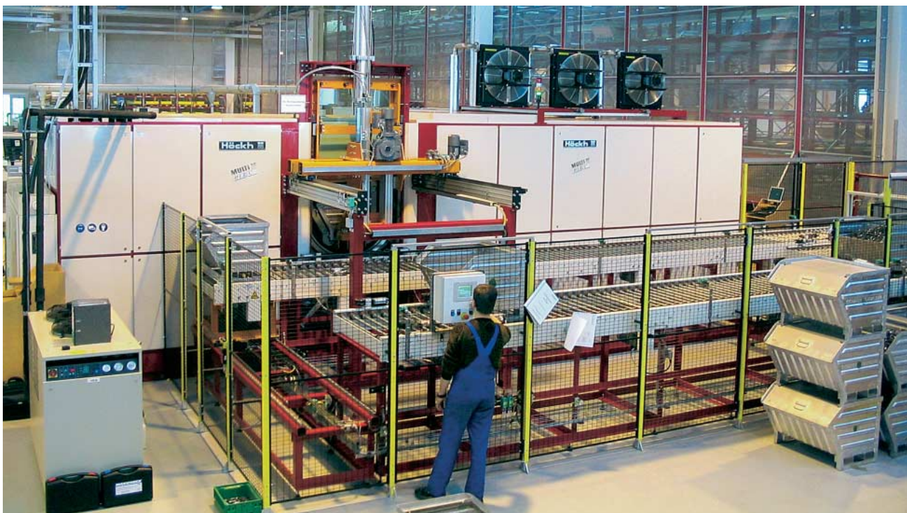
Die Vakuum-Reinigungsanlage vom Typ Multiclean arbeitet mit Perchlorethylen
