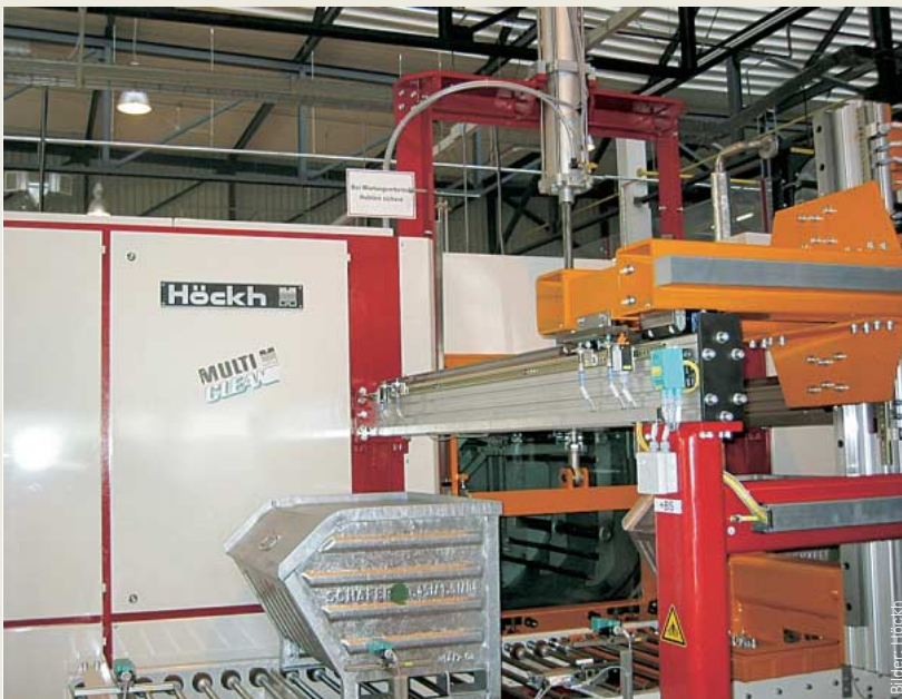
▲ Die Portal-Ladeeinrichtung für Warenkörbe bis zu 450 kg
