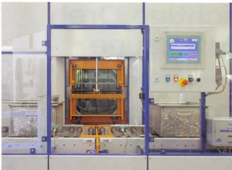
Für einen in China produzierenden deutschen Hersteller von Tiefzieh- und Umformteilen installierte die Höckh GmbH die »Multiclean-2-5-F«, die in der Lage ist, dank zweier Reinigungskreisläufe sowie einem Konservierungskreislauf hocheffektiv verunreinigte Metallteile umwelt-schonend zu reinigen.
