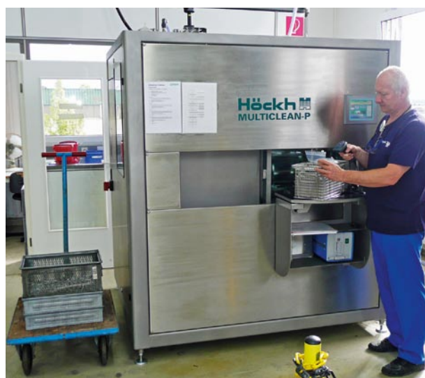
Zur Chargendokumentation verfügt die Feinst-Reinigungsanlage über einen Barcodescanner und eine Anbindung ans Firmennetzwerk
