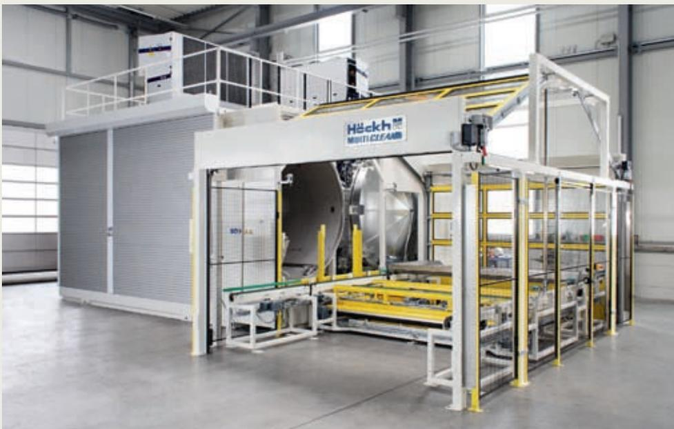
In dieser Anlage werden Composite-Strukturbauteile für die Luftfahrtindustrie unter Voll-Vakuum gereinigt. Zur leichteren Wartung ist die Anlage rundum mit elektrischen Rollläden verschlossen.
