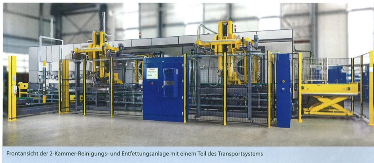
Frontansicht der 2-Kammer-Reinigungs- und Entfettungsanlage mit einem Teil des Transportsystems
