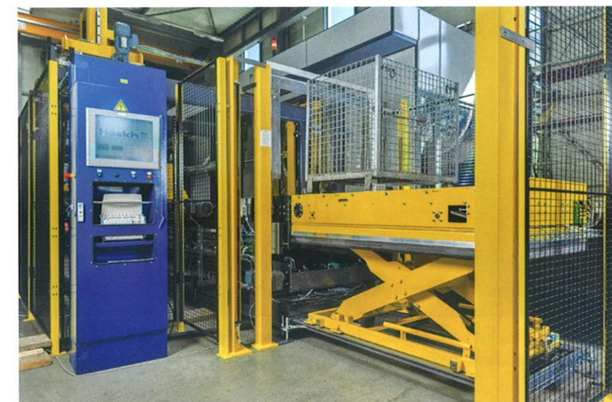
Die Gitterboxen werden mittels Gabelstapler auf die Anlage gesetzt. Große Grafik-Bedienfelder erlauben eine einfache Bedienung und Überwachung der komplexen Anlage.
