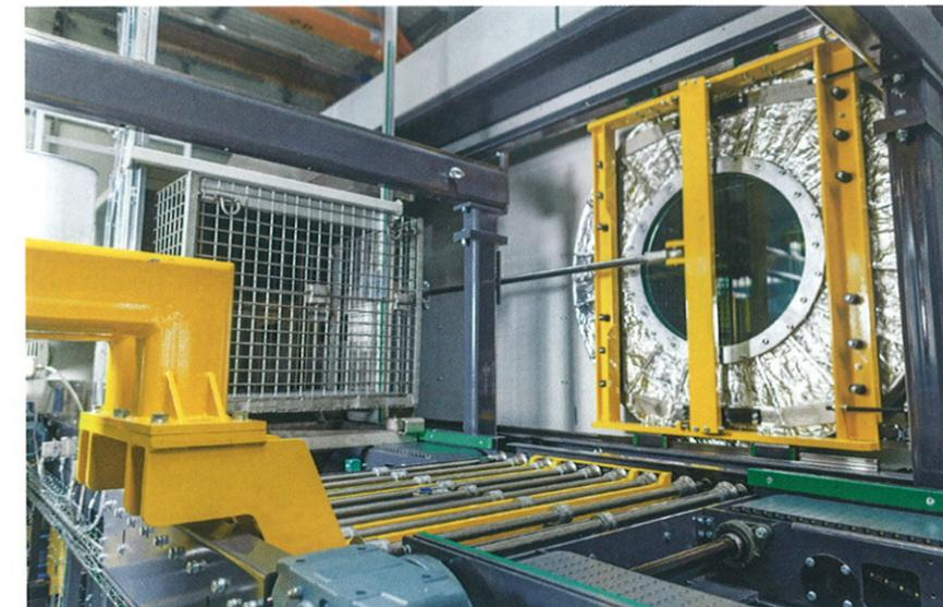
Ein großes Bullauge in den Arbeitskammer-Türen gewährt Einblicke in den Reinigungs- und Trocknungsprozess
