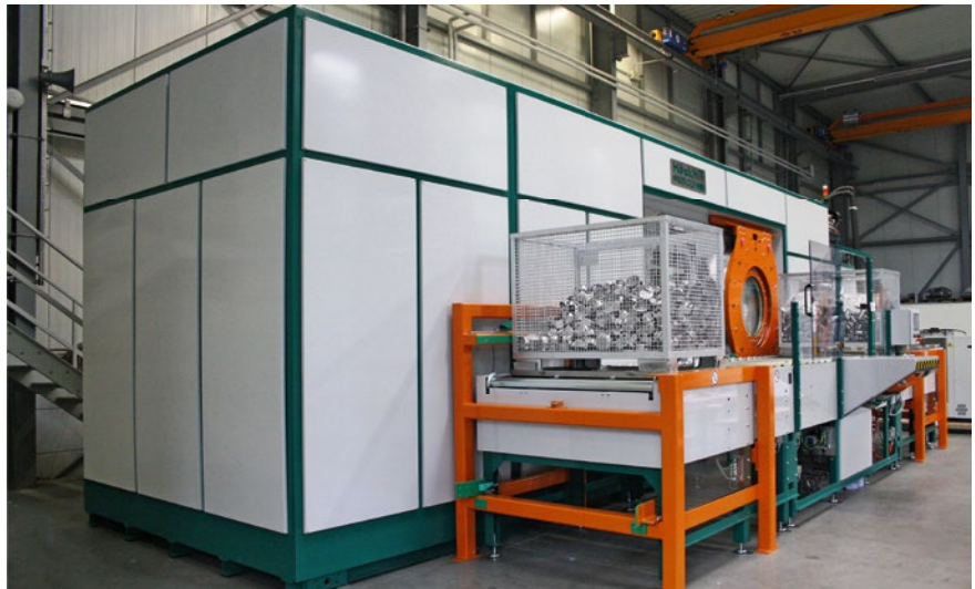
Gesamtansicht der Vollvakuum-Reinigungsanlage für Euro-Gitterboxen – hier in der Variante mit drei Tankkreisläufen. Die Beschickung erfolgt bauseits mittels Stapler, die Staurollenbahn führt dann die Gitterboxen im 20-Minuten-Takt der Anlage zu.
