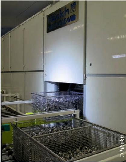
Automatisches Be- und Entladen von Körben mit bis zu 150 Kilogramm
