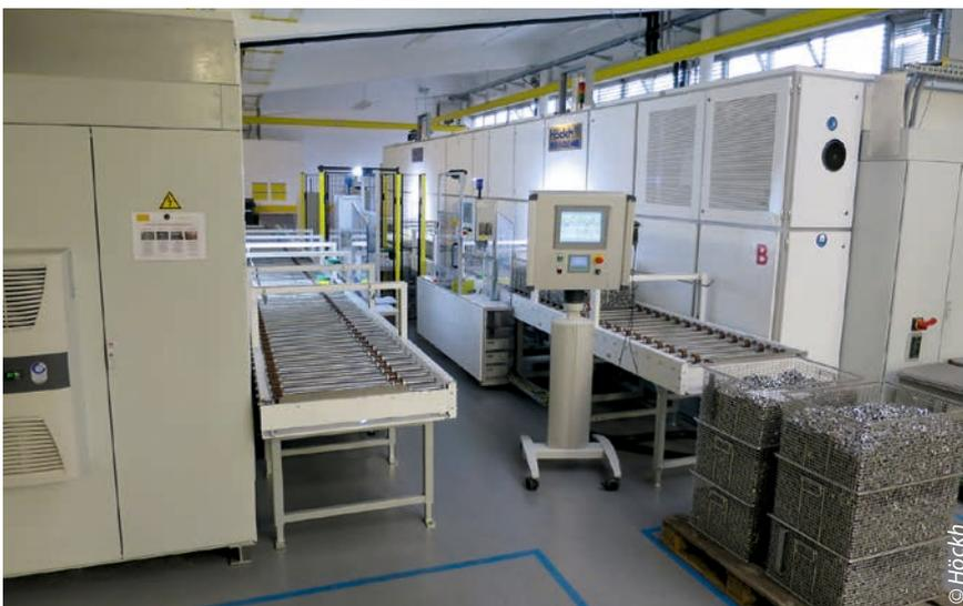
Im neuen Reinigungszentrum können bis zu drei Tonnen Material pro Stunde wässrig und mit Lösemittel gereinigt werden
